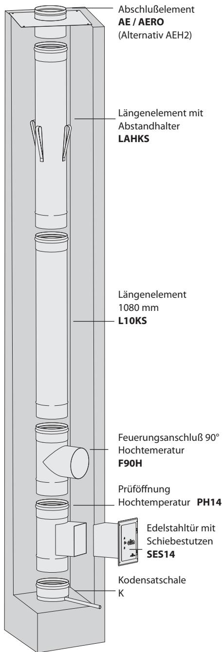
Die Dimensionierung der Anlage ist mit einem zugelassenen Schornsteinberechnungsprogramm nach EN 13384-1/2 durchzuführen.
