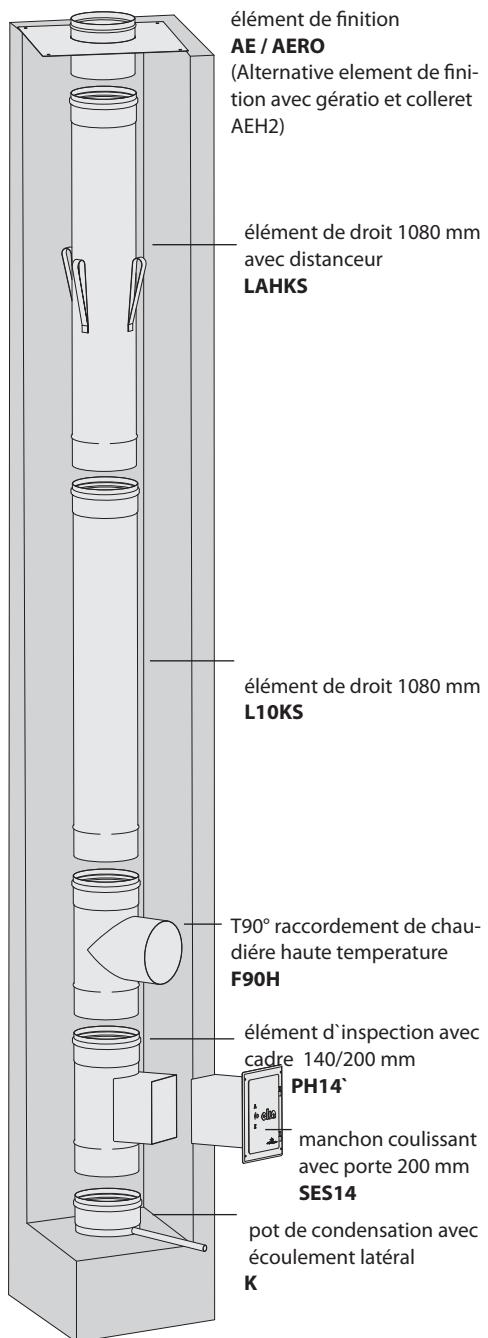
Les éléments droits L10 ont une longueur de 1000 mm. Les éléments plus courts sont disponibles, L5 (longueur utile de 460 mm) ou L3 (longueur utile de 280 mm). D'autres dimensions sont possibles par l'utilisation d'éléments à doubles manchons re-coupables. Le tronçonnage du conduit ne peut s'effectuer qu'avec un outil approprié muni d'un disque inox.
